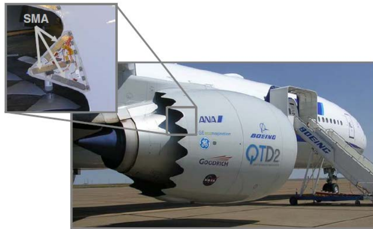
Figura 2. 8 – Aplicação de SMA nos motores de um Boeing [1].
